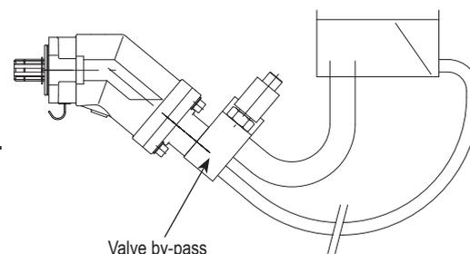
► **Mode de fonctionnement de la valve by-pass**
